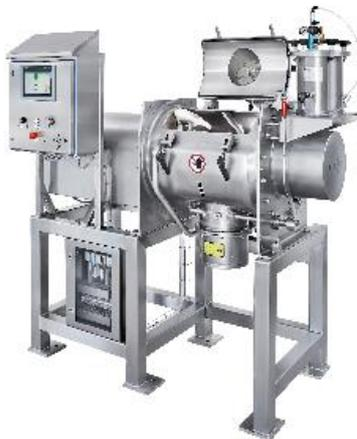
Zur Produktion von kosmetischen Puderprodukten hat sich in vielen Fällen der Einsatz von horizontalen Pflugschar®-Mischern im Chargenbetrieb bewährt. Diese arbeiten nach dem von Lödige in die industrielle Mischtechnik eingeführten Schleuder- und Wirbelverfahren, das einen hohen Energieeintrag und eine sehr gute Durchmischung gewährleistet.
