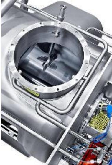
Durch eine Schwarz-Weiß-Trennung kann die Verschleppung von Kontaminationen verhindert werden. Technisch bedeutet das zum Beispiel, den Motor zum Antrieb eines Mixers oder einer anderen verfahrenstechnischen Maschine räumlich von der Maschine selbst zu trennen.
