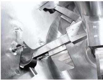
Durch den Einsatz von Messerköpfen werden ggf. auftretende Agglomerate zerkleinert, damit die in den Agglomeraten eingeschlossene Feuchtigkeit zügig entfernt werden kann. (Quelle: Lödige)
