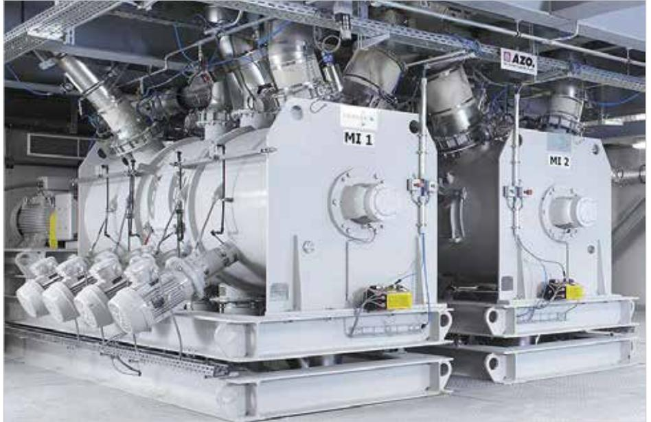
Lödige Pflugschar®-Mischer für Chargenbetrieb Typ FKM 4200 D für die Aufbereitung von Spezial-Kleber
