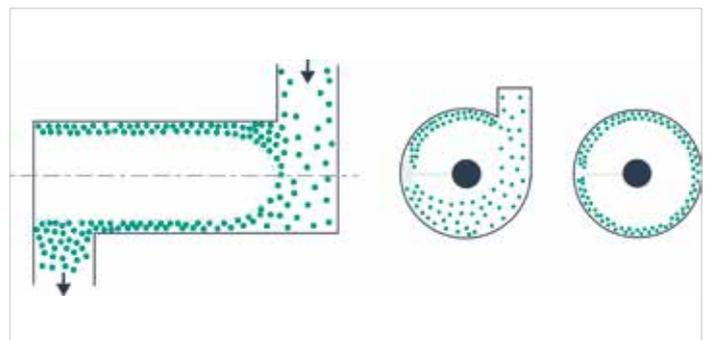
Prinzip des Ringschicht-Mischer
