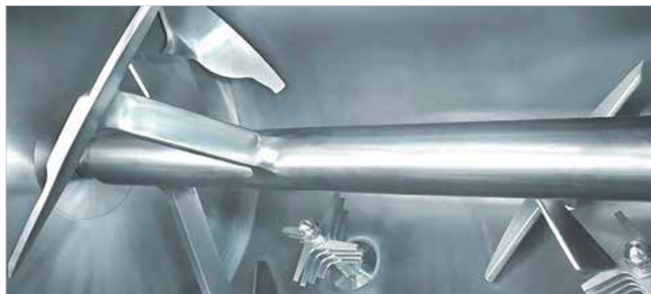
Festverschweißtes Schleuderwerk im hygienischen Design
