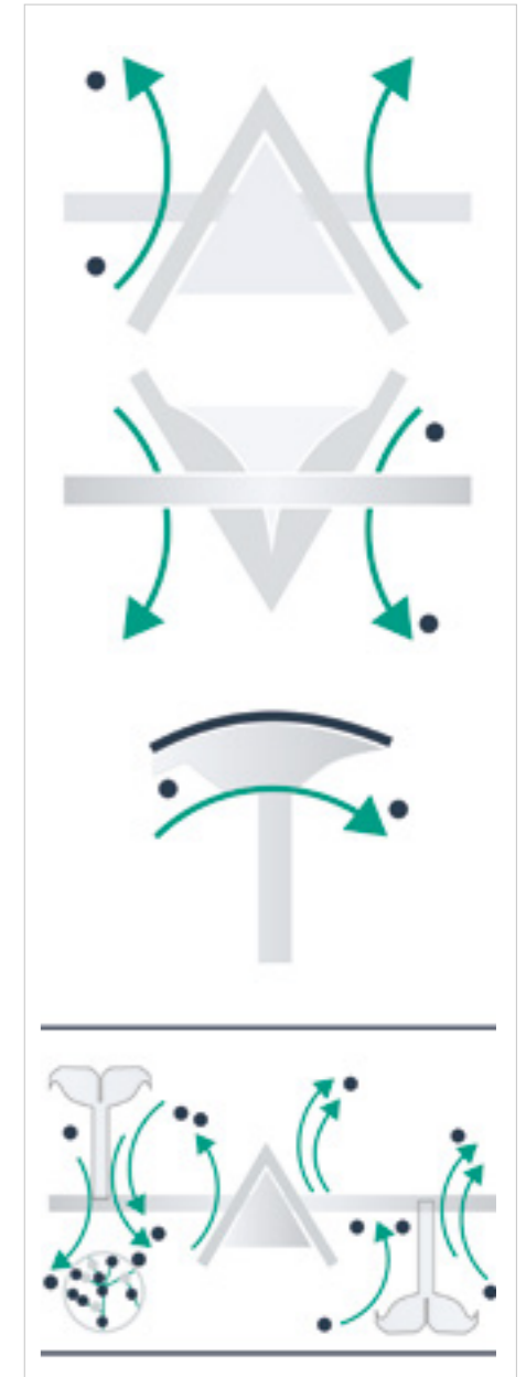
Schematische Darstellung des mechanisch erzeugten Wirbelbetts.
