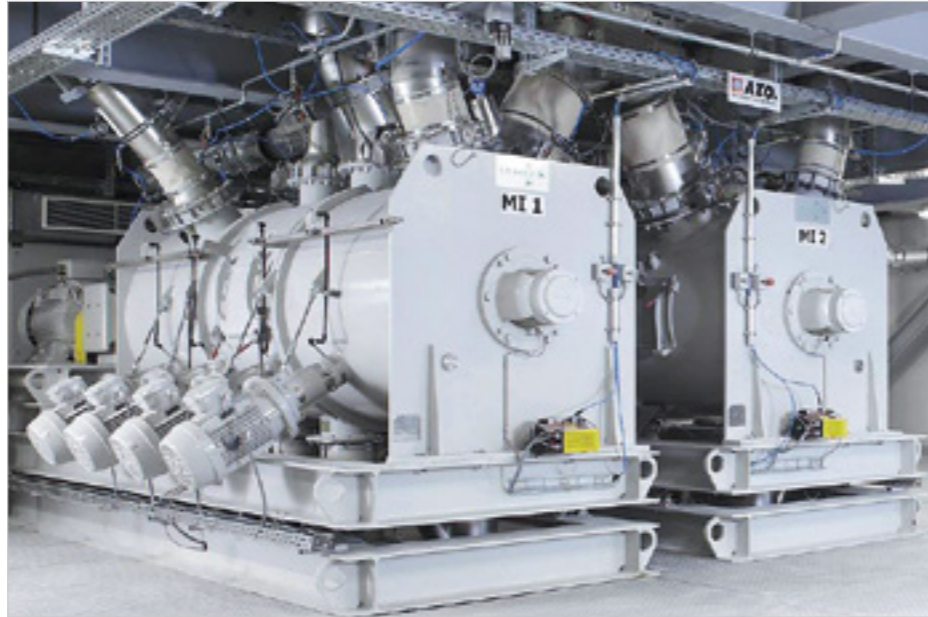
Lödige Pflugschar®-Mischer für Chargenbetrieb Typ FKM 4200 D für die Aufbereitung von Spezial-Kleber
