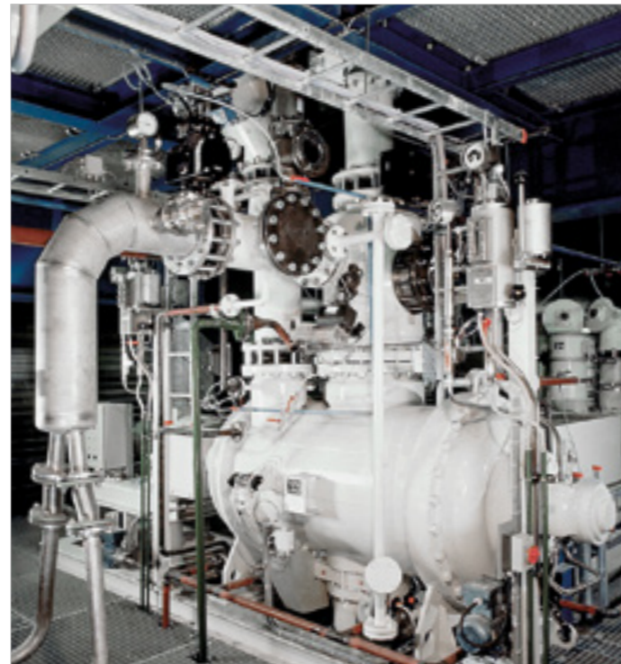
Lödige Prozessanlage mit Doppelmantel zur Aufbereitung von Spezial-Mischungen
